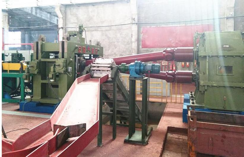
安阳锻压 120mm 耐磨热轧钢球生产线出口亚美尼亚
