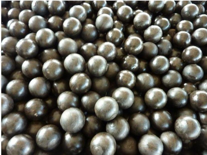
锻造的耐磨钢球表面质量好，抗冲击性好，韧性强，耐磨性好，不易破碎和失圆。就是将金属加热温度达 700—1300℃，利用锻压机械对金属坯料施加压力，使其产生塑性变形以获得具有一定机械性能、一定形状和尺寸锻件的加工方法。锻压(锻造与冲压)的两大组成部分之一。通过锻造能消除金属在冶炼过程中产生的铸态疏松等缺陷，优化微观组织结构，同时由于保存了完整的金属流线，锻件的机械性能一般优于同样材料的铸件。相关机械中负载高、工作条件严峻的重要零件，除形状较简单的可用轧制的板材、型材或焊接件外，多采用锻件。此外，锻造钢球要耐磨必须选用最耐磨的材料，比如国标的 60Mn、65Mn，或有些公司自主研发的高效耐磨合金钢材料，并且建议采用国家特大型钢厂生产的钢材，同样是一种材料，在不同的钢厂生产出来的质量也是不等的，而锻件的质量好坏 80%取决于材料的好坏，比如采用高锰钢，抗冲击性好，韧性强，耐磨性好，不易破碎。
