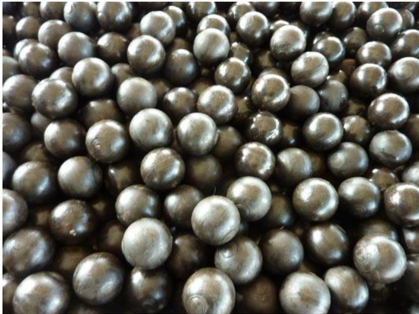
锻造的耐磨钢球表面质量好，抗冲击性好，韧性强，耐磨性好，不易破碎和失圆。就是将金属加热温度达 700—1300℃，利用锻压机械对金属坯料施加压力，使其产生塑性变形以获得具有一定机械性能、一定形状和尺寸锻件的加工方法。锻压(锻造与冲压)的两大组成部分之一。通过锻造能消除金属在冶炼过程中产生的铸态疏松等缺陷，优化微观组织结构，同时由于保存了完整的金属流线，锻件的机械性能一般优于同样材料的铸件。相关机械中负载高、工作条件严峻的重要零件，除形状较简单的可用轧制的板材、型材或焊接件外，多采用锻件。此外，锻造钢球要耐磨必须选用最耐磨的材料，比如国标的 60Mn、65Mn，或有些公司自主研发的高效耐磨合金钢材料，并且建议采用国家特大型钢厂生产的钢材，同样是一种材料，在不同的钢厂生产出来的质量也是不等的，而锻件的质量好坏 80%取决于材料的好坏，比如采用高锰钢，抗冲击性好，韧性强，耐磨性好，不易破碎。锻造钢球因为经济耐用等特点深受广大用户青睐，例如国际矿业巨头力拓、必和必拓、安格鲁黄金等均使用锻造钢球。
