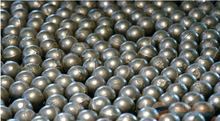
铸造钢球——主要使用收集来的废钢料，加配一定比例的合金元素，铸造而成。
