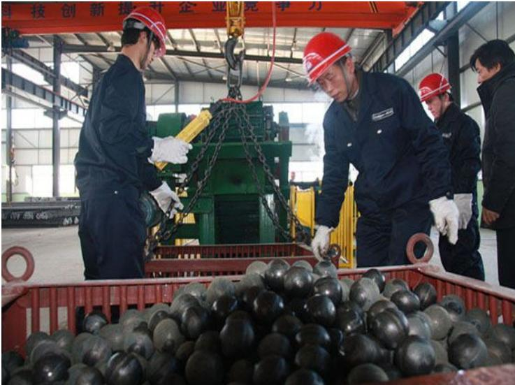
热轧钢球——材料属于低合金高碳钢，使用的是正规特钢厂生产的成品圆钢，同时要求特钢厂采用 10 倍以上体积的方钢坯热轧挤压生产而成；
