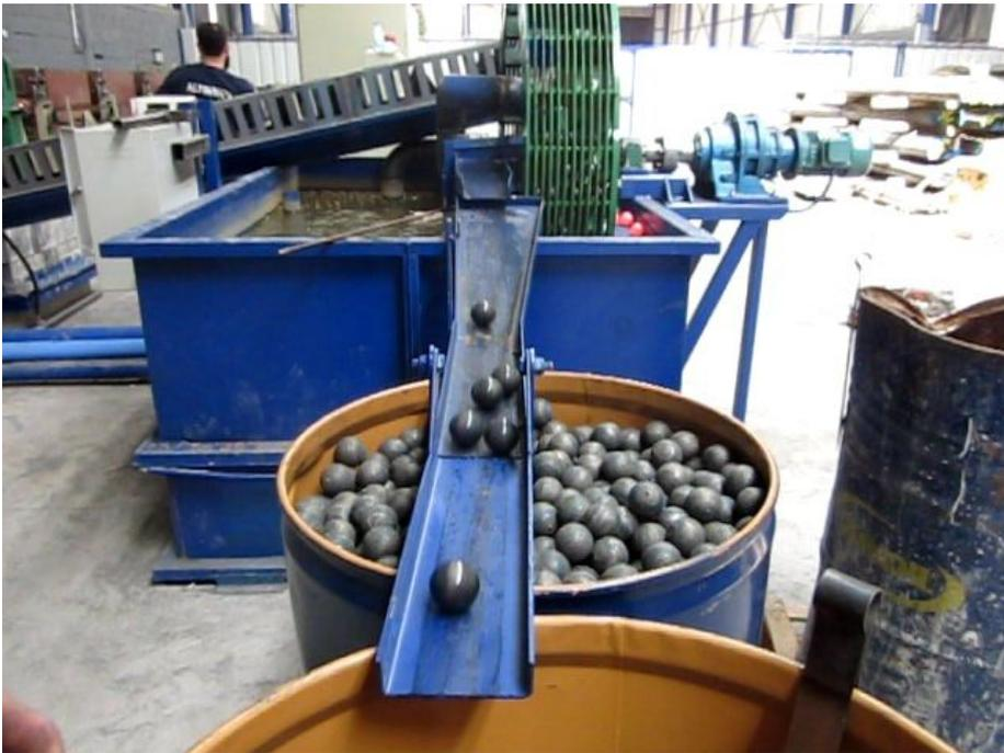
铸球主要是靠掺入一定量的合金元素铬（Cr）来使钢球产生一定的硬度和耐磨性，Cr 的含量越高，球的硬度和耐磨性越好。但钢球的成本也越高；目前国内含 Cr 量最高达 18%，硬度为 60~62HRC，耐磨性很好，但价格较高。
